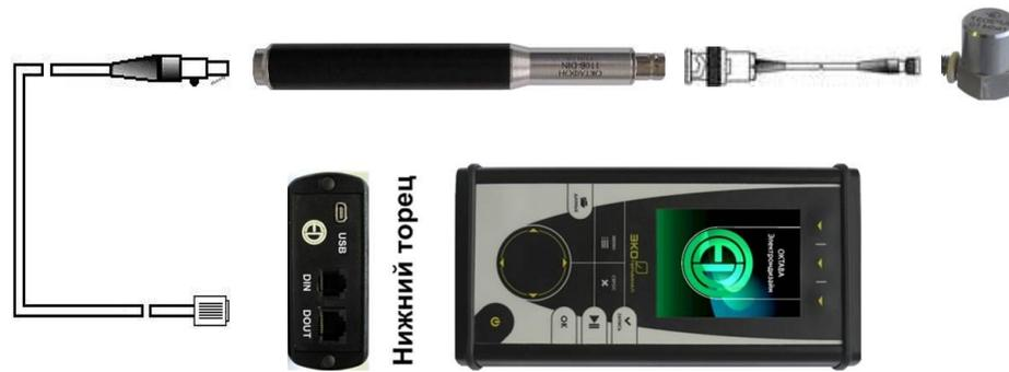
Рис.2. Подключение ОКТАФОН-110В с датчиком AP37 к ИБ ЭКОФИЗИКА-D
