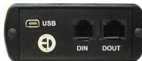
Для получения доступа к файлам энергонезависимой памяти прибора необходимо соединить USB порт прибора, расположенный на нижнем торце, с USB-портом компьютера. Для этого используется кабель КИ-ЭФ или любой стандартный кабель с разъемами miniUSB-USB, имеющимися в свободной продаже.
