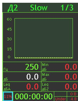
Если в меню выбранного при постобработке сигнала настроен режим «Мультизапись» или «Мониторинг», то вы сможете не только видеть результаты постобработки на экране, но и сохранить их в отдельном независимом файле, нажав клавишу ЗАПИСЬ.
