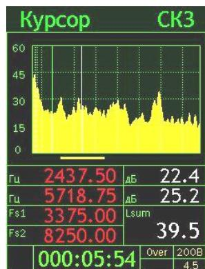
Это окно служит для спектральной оценки сигнала и задания центральной частоты селективного вольтметра. Настроив параметры окна «Микровольтметр», выбрав в первой строке «БПФ» и нажав клавишу МЕНЮ или ОК, вы перейдете в окно БПФ. Повторное нажатие клавиши МЕНЮ возвращает в меню «Микровольтметр».
