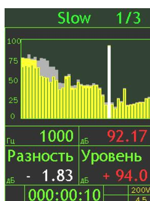
течение нескольких секунд, и нажмите клавишу ЗАПИСЬ. Автокалибровка завершена. Новая калибровочная поправка автоматически появится в поле «Поправка».
