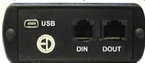
Порт USB предназначен для работы с файлами энергонезависимой памяти прибора, порт DOUT – цифровой выход – для работы с прибором в режиме телеметрии, порт DIN – для подключения цифровых датчиков.
