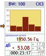
Прибор переходит в окно вольтметра, в котором центральная соответствует частота частоте курсора. Одновременное нажатие клавиш [ДАННЫЕ]+[ОК] (c последовательным уменьшением ширины полосы селекции **BW**) подстраивает центральную частоту вольтметра так, чтобы она соответствовала истинной частоте сигнала. Для стационарных сигналов погрешность алгоритма определения частоты не превышает 0,01  $\Gamma$ ц либо  $f_c$  х  $10^{-5}$  (выбрать наибольшее), где  $f_c$  – центральная частота в герцах.
