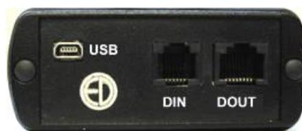
Для получения доступа к файлам энергонезависимой памяти прибора необходимо соединить USB порт прибора, расположенный на нижнем торце, с USB-портом компьютера. Для этого используется кабель с разъемами miniUSB-USB.
