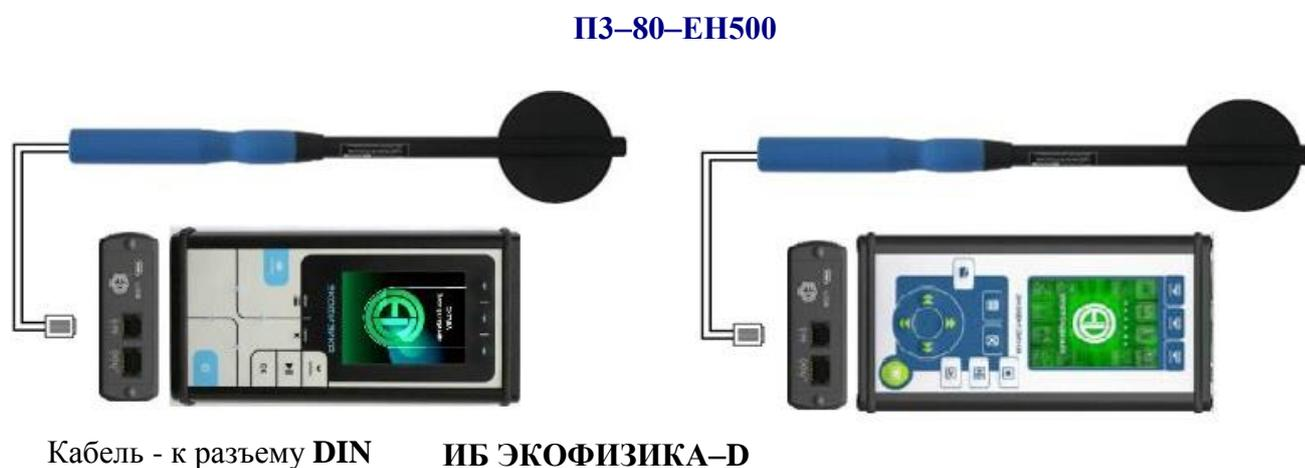
*Рис.1.* Подключение ПЗ-80-ЕН500 к ИБ ЭКОФИЗИКА-Д
