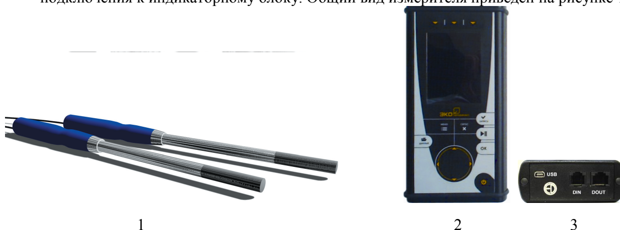
Рис.1. Общий вид измерителя. 1 – измерительные зонды, 2 – индикаторный блок (лицевая панель); 3 – индикаторный блок (вид снизу)
